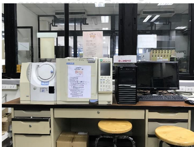
รูปที่ 3.10 เครื่องแก๊สโครมาโทกราฟ-แมสสเปกโตรเมตรี
