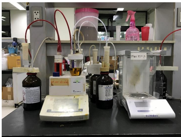
รูปที่ 3.11 เครื่องหาปริมาณน้ำคาร์ล ฟิสเซอร์
