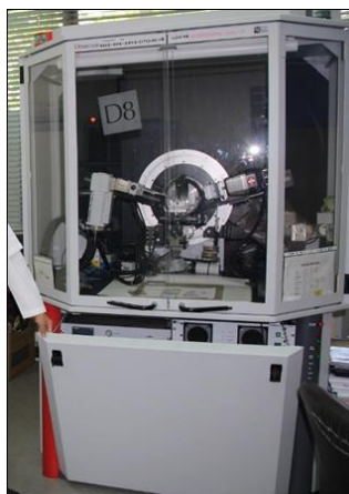
รูปที่ 3.4 เครื่อง X-Ray Diffractometer ของบริษัท Bruker รุ่น D8 Discover
