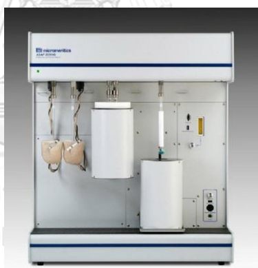
รูปที่ 3.7 เครื่อง Surface area and porosity analyzer ของบริษัท Micromeritics รุ่น ASAP 2020
