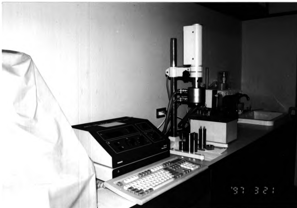
รูปที่ 11 ภาพถ่ายของ viscometer (Rotovisco) รุ่น RV 20 จาก HAAKE วัด viscosity ตั้งแต่ 1.0 - 2 \times 10^6 cP
