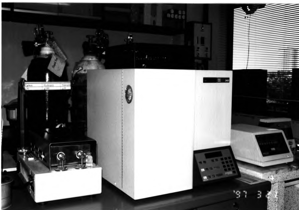
รูปที่ 13 ภาพถ่ายของ CHNS / O analyser (PERKIN ELMER PE 2400 SERIES 2 : OPTIO CHNS ) จากศูนย์ เครื่องมือวิจัยวิทยาศาสตร์ และเทคโนโลยี จุฬาลงกรณ์มหาวิทยาลัย
