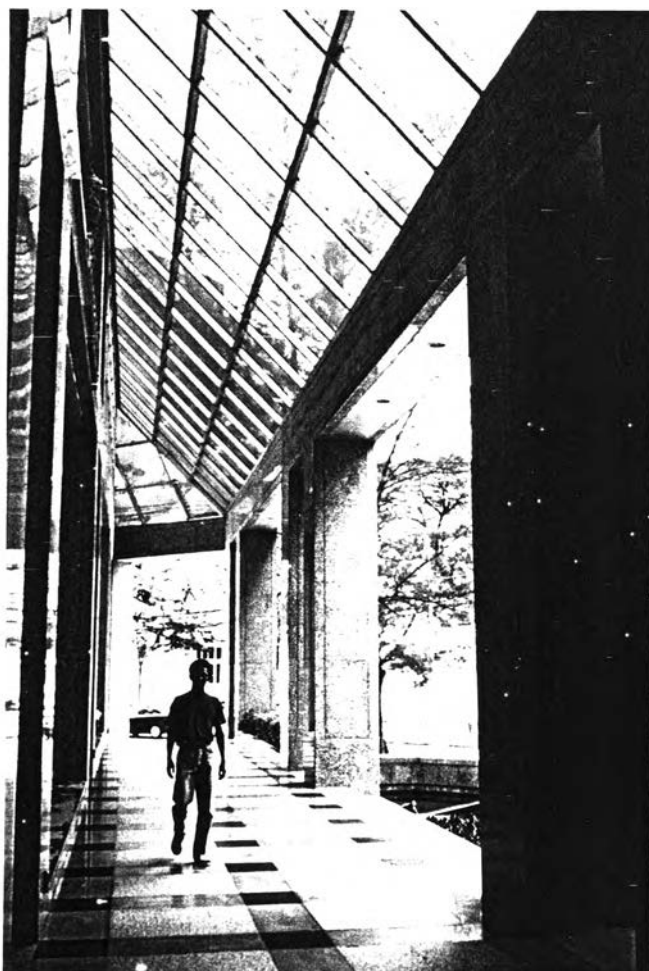
ภาพที่ 206 เพื่อป้องกันฝุ่นดินทรายและสิ่งสกปรกติดรองเท้าเข้าไปภายในอาคาร:- - ทางเดินภายนอกอาคารมีหลังคาปกคลุม
