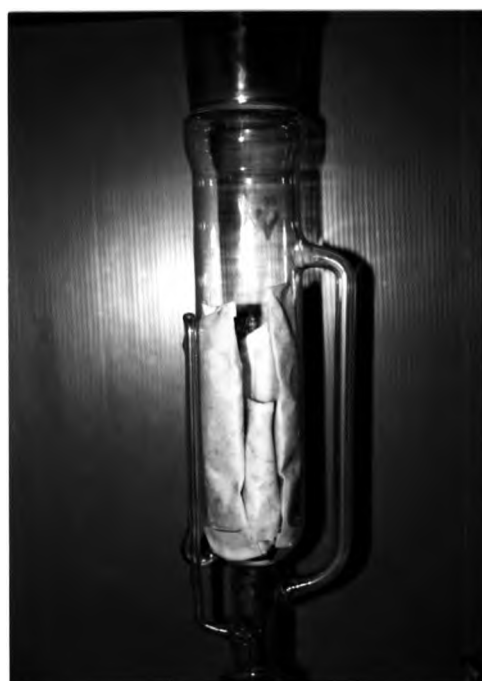
2. บรรจุเซลล์แห้งลงในถุงกระดาษกรอง แล้วใส่ในส่วน extraction สกัดด้วยคลอโรฟอร์ม
