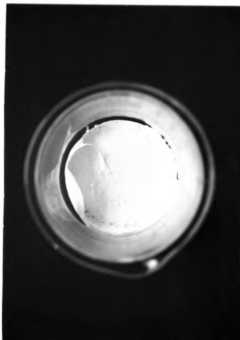
4. นำแผ่นฟิล์มมาทำให้บริสุทธิ์ โดยการตกตะกอนด้วยเฮกเซน
