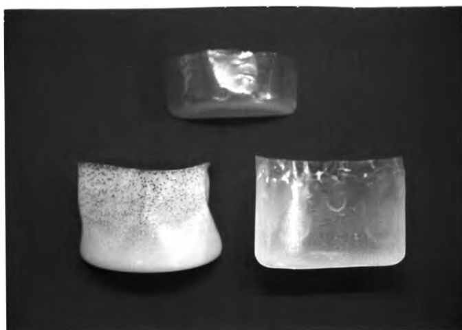
5. ตัวอย่างลักษณะของสารเทอร์พอลิเมอร์ P(3HB-co-3HV-co-4HB)บริสุทธิ์ ซึ่งมีสมบัติเป็นเทอร์โมพลาสติกสามารถขึ้นรูปตามแบบของแม่พิมพ์ได้ (ในภาพ คือ ลักษณะของเทอร์พอลิเมอร์จากแม่พิมพ์บีกเกอร์)
