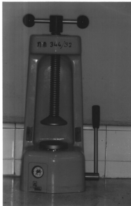
รูปที่ 3 - 8 แสดงเครื่องอัดพลาสติกไฮดรอลิก รุ่น EWL 5414
