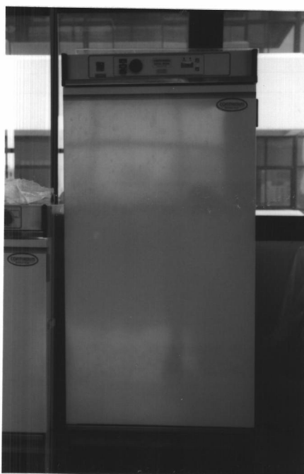
รูปที่ 3 - 14 แสดงตู้ควบคุมอุณหภูมิและความชื้น
