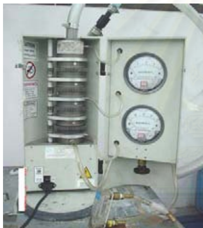
รูปที่ 3.5 อุปกรณ์คัดขนาดฝุ่นละออง (MOUDI)
