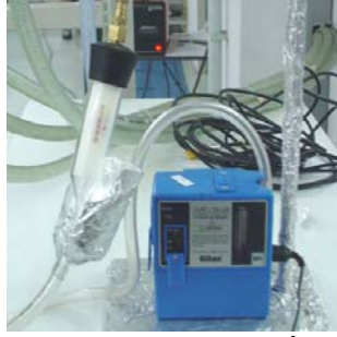
รูปที่ 3.6 ชุดเก็บตัวอย่างหลอด PUF และเครื่อง personal air sampler
