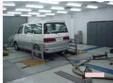
รูปที่ ก-2 การทดสอบรถยนต์ดีเซลเล็กบนแท่นทดสอบ
