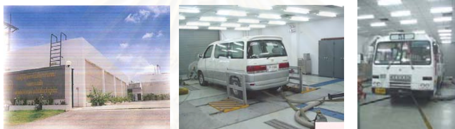
รูปที่ 3.1 ห้องปฏิบัติการตรวจวัดมลพิษจากยานพาหนะชนิดดีเซลเล็กและดีเซลใหญ่
