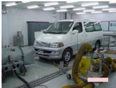
รูปที่ ก-2 การทดสอบรถยนต์ดีเซลเล็กบนแท่นทดสอบ
