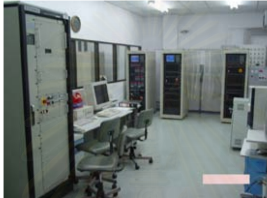
รูปที่ ก-1 ห้องควบคุมและการทดสอบรถยนต์ดีเซลใหญ่บนแท่นทดสอบ
