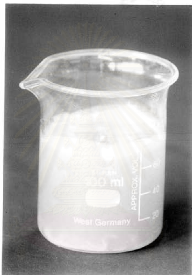
สถาบันวิทยบริการ จุฬาลงกรณ์มหาวิทยาลัย Figure 5-21 Unsaturated polyester liquid synthesized from PET bottles
