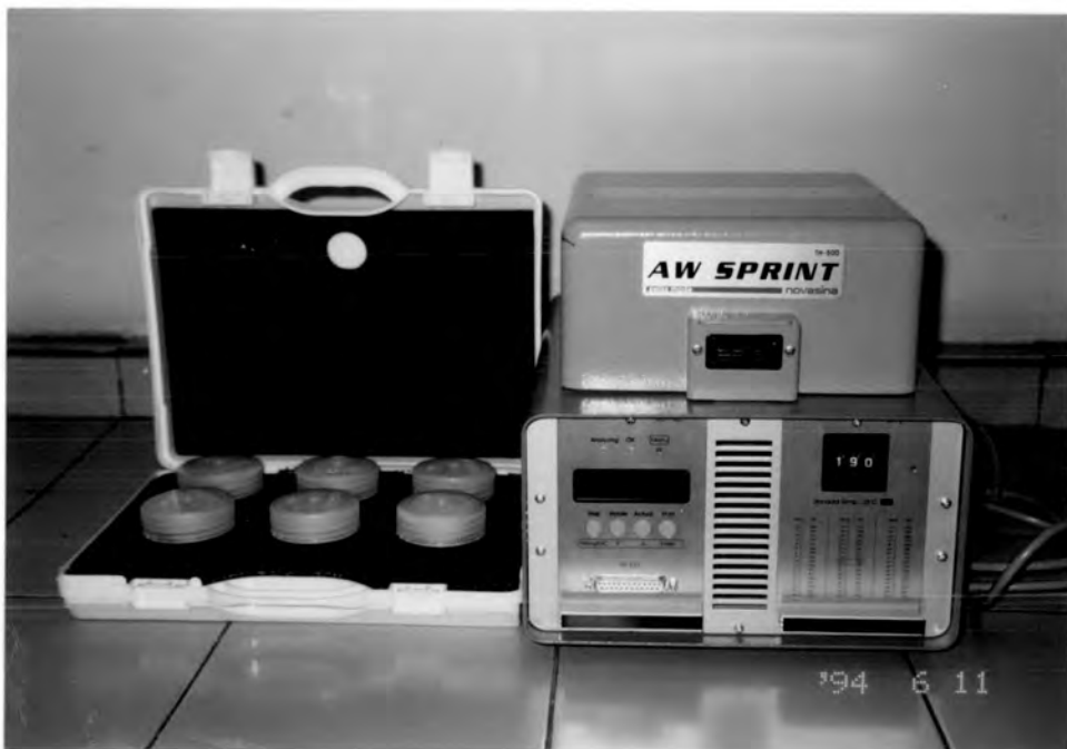
รูปที่ จ.10 เครื่องวัดค่า water activity ( a_w Sprint) (Novasina, TH500)
