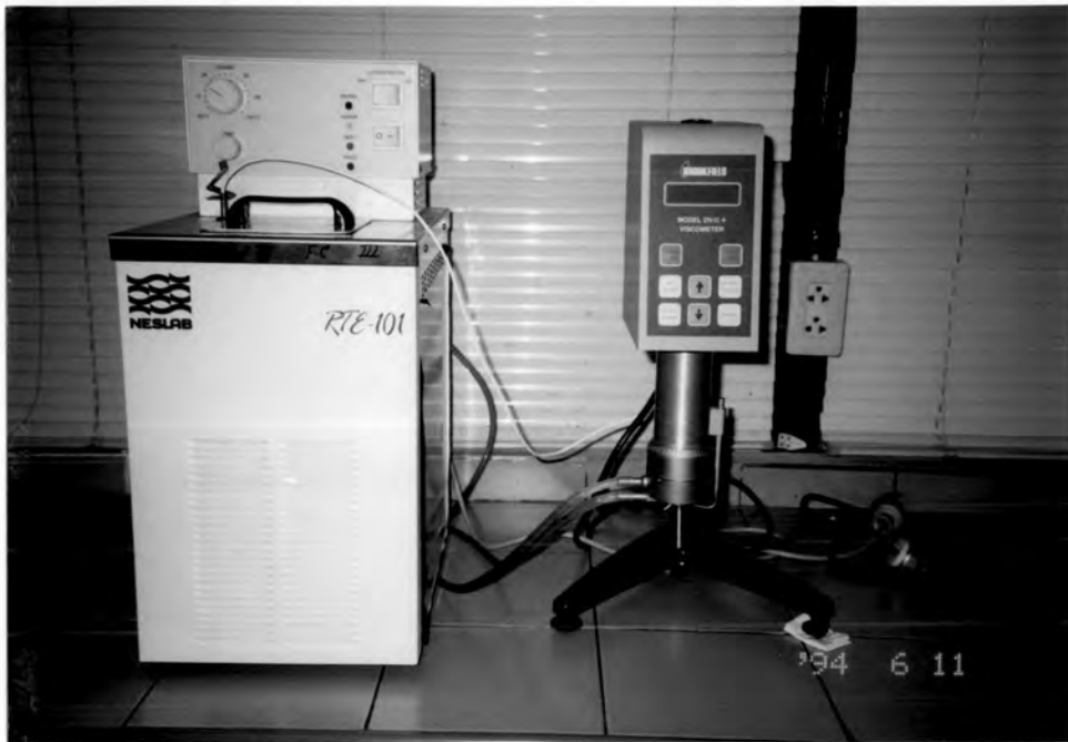
รูปที่ จ.9 เครื่องวัดความหนืด (Brookfield Viscometer, DV II Plus)
