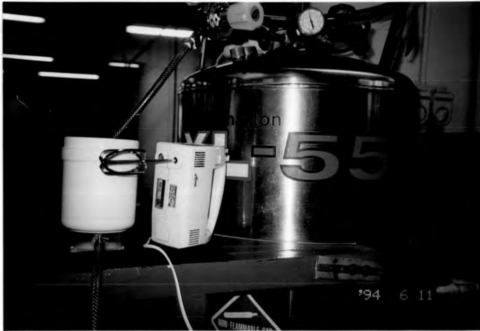
รูปที่ จ.5 โถปั่นที่ประดิษฐ์ขึ้นที่มีการต่อท่อก๊าซไนโตรเจนจากถังไนโตรเจนเหลว
