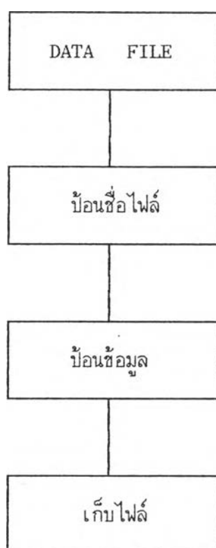
รูปที่ 4.3 แสดงขั้นตอนของฟังก์ชัน DATA FILE
