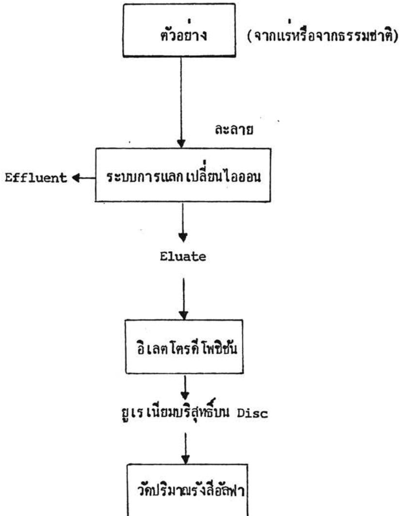
1.4.3 ทำอิลคโตรคีโพซิชั่น ยูเรเนียมบนแผ่นทองแดงชุบนิกเกิลและแผ่นเหล็ก-โรสนิม โดยทำกับสารมาตรฐานของยูเรเนียมก่อน และ เปลี่ยนความเข้มข้นของยูเรเนียมในสารมาตรฐานใหม่ค่าต่าง ๆ กัน (ระดับ 10-100 ไมโครกรัม) เพื่อเตรียมเป็นเส้นกราฟมาตรฐานที่จะใช้ในการคำนวณต่อไป แล้วจึงทำอิลคโตรคีโพซิชั่นของตัวอย่าง
