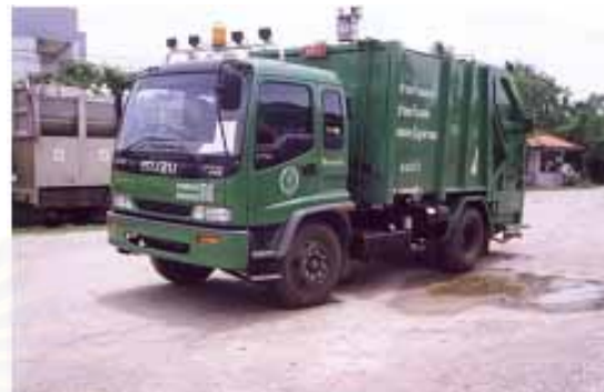
รถเก็บขยะแบบอัดท้าย (Compact Truck) ขนาดความจุ 5 ตัน
