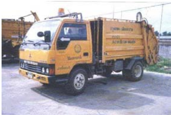
รถเก็บขยะแบบอัดท้าย (Compact Truck) ขนาดความจุ 2 ตัน
