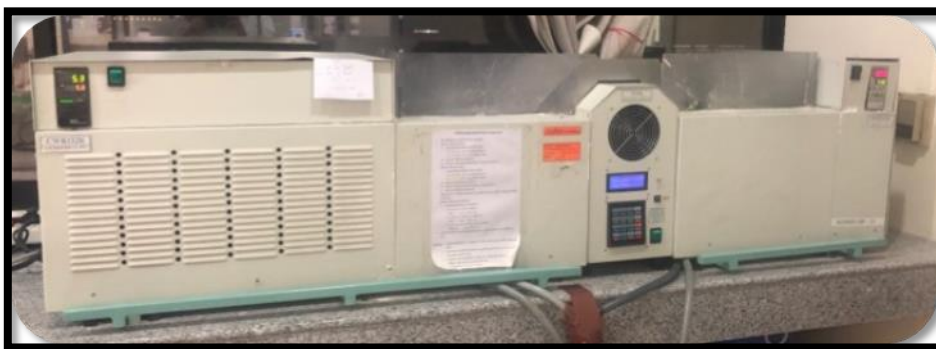
ภาพที่ 18 เครื่องควบคุมอุณหภูมิแบบร้อนเย็น
