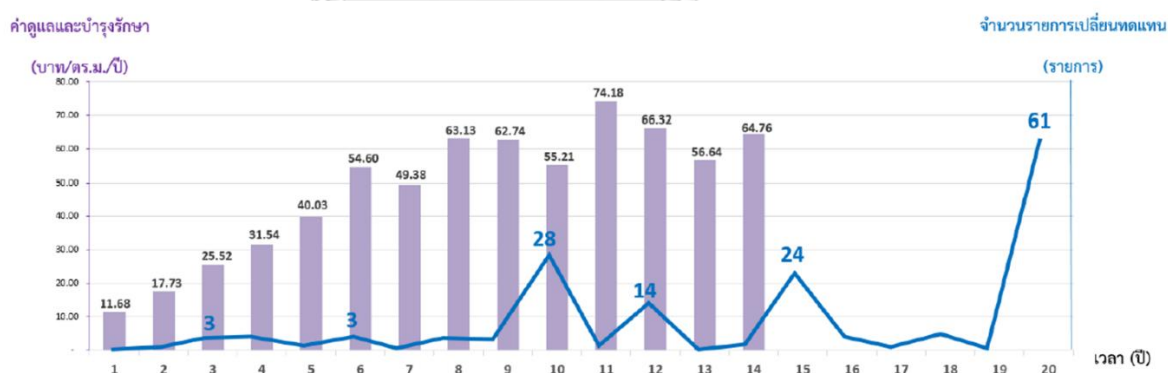
ภาพที่ 7.3 ความสัมพันธ์ระหว่างกรอบแนวคิดรอบอายุเชิงทฤษฎีและค่าใช้จ่ายการซ่อมแซมและดูแลบำรุงรักษา
