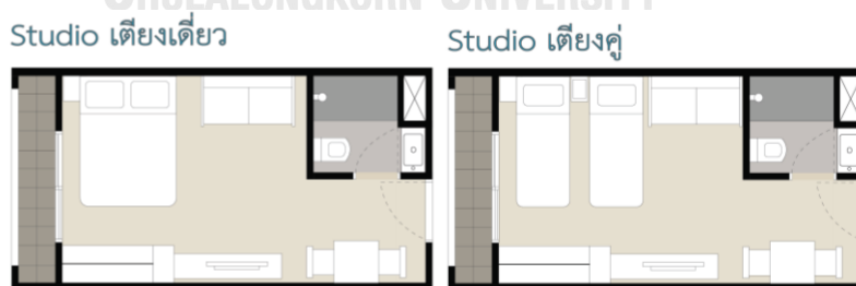
รูปที่ 6.2 แผนผังแสดงตัวอย่างห้องพักกลุ่มอะพาร์ตเมนต์ แมนชั่น ห้องเช่ารายวัน
