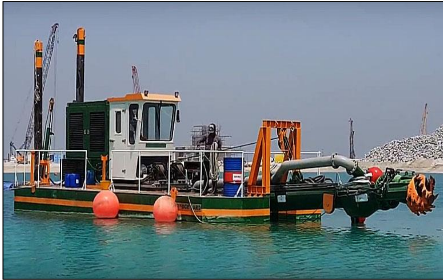
ภาพที่ 2.10 เรือขุดแบบหัวสว่าน cutter dredger ที่มา: Dutchwatersector (2018)
