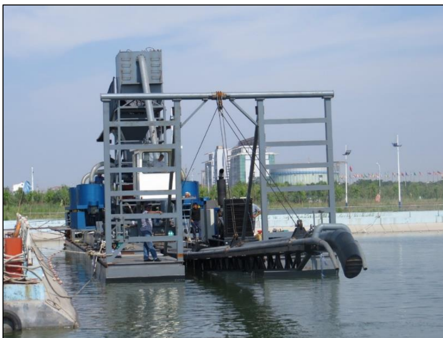
ภาพที่ 2.9 เรือขุดแบบดูดธรรมดา plain suction dredger
