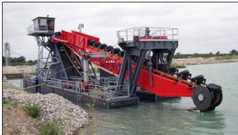
ภาพที่ 2.7 เรือขุดแบบถ้ำย bucket or ladder dredger ที่มา: Aggdredge (2017)
