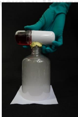
ภาพที่ 3.12 การเคลือบผิวชิ้นงานด้วยเครื่องฟ่น Nano Ultrasonic Atomizer (สีผสมอาหาร)
