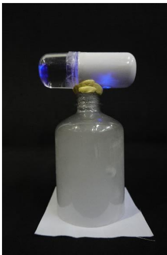
ภาพที่ 3.15 การเคลือบผิวชิ้นงานด้วยเครื่องพ่น Nano Ultrasonic Atomizer (เพอร์เมทริน)
