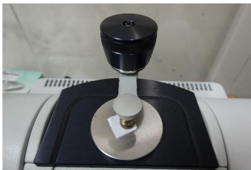
ภาพที่ 3.17 ทดสอบการติดสารเพอร์เมทรินด้วยเครื่อง FT-IR Spectrometer
