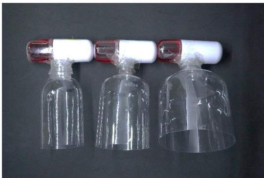
ภาพที่ 3.3 การประกอบเครื่องพ่นเข้ากับกระบอกใส
