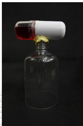
ภาพที่ 3.9 การบรรจุสีย้อมอาหารในเครื่องพ่น Nano Ultrasonic Atomizer
