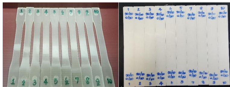
รูปที่ 3.6 ชิ้นทดสอบที่เตรียมได้จากเครื่องฉีดแบบ
