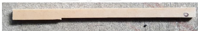
รูปที่ 3.22 ชิ้นทดสอบตามมาตรฐาน ASTM D2863
