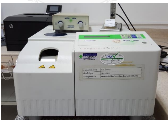
รูปที่ 3.18 เครื่องวิเคราะห์น้ำหนักภายใต้ความร้อน (TGA)
