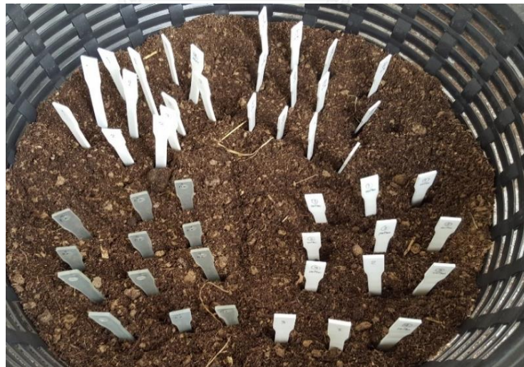
รูปที่ 3.21 การทดสอบการย่อยสลายทางชีวภาพโดยการฝังดิน
