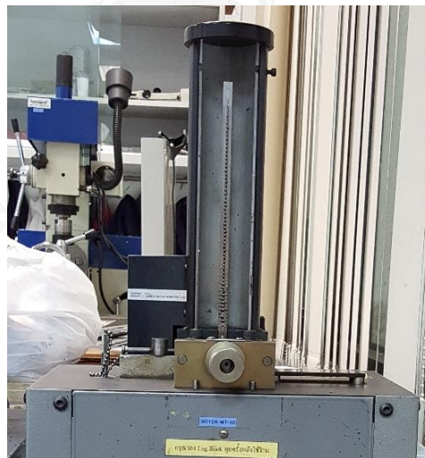
รูปที่ 3.12 เครื่องบาชั่งงานทดสอบสมบัติด้านทานแรงกระแทก
