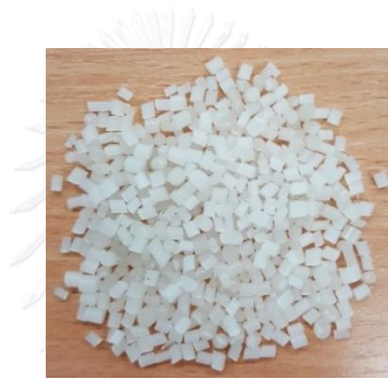
รูปที่ 3.5 เม็ดพอลิเมอร์ผสมที่ผ่านการผสมด้วยเครื่องอัดรีดแบบเกลียวคู่
