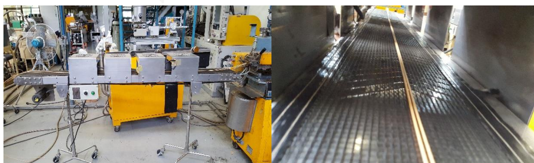
รูปที่ 3.7 ระบบหล่อเย็นด้วยระบบลมพัด
