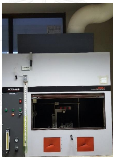
รูปที่ 3.24 เครื่องทดสอบการลุกลามไฟ UL-94
