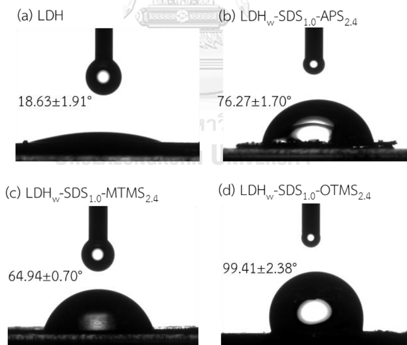
รูปที่ 4.14 มุมสัมผัสน้ำของ MgAl LDH ที่ผ่านการดัดแปรด้วยชนิดสารคู่ควบไซเลนที่แตกต่างกัน (a) LDH (b) LDH w -SDS 1.0 -APS 2.4 (c) LDH w -SDS 1.0 -MTMS 2.4 และ (d) LDH w -SDS 1.0 -OTMS 2.4
