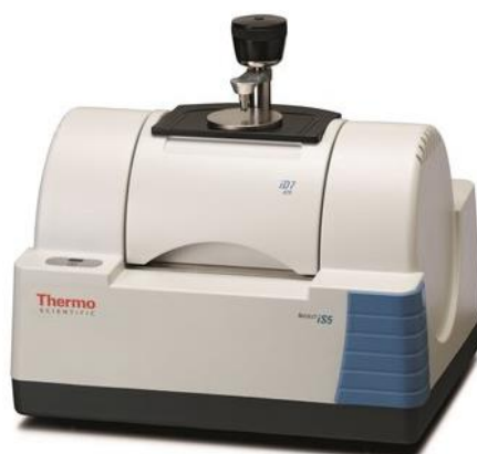
รูปที่ 3.8 เครื่อง Attenuated total reflection-Fourier transform infrared spectrometer (ATR-FTIR) ยี่ห้อ Thermo Fisher Scientific รุ่น Nicolet iS5 [39]
