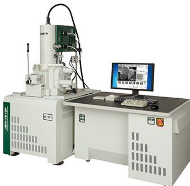
รูปที่ 3.13 เครื่อง Field emission scanning electron microscope ยี่ห้อ JEOL รุ่น JSM-7610F [43]
