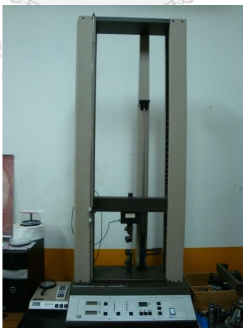
รูปที่ 3.15 เครื่อง Universal testing machine ยี่ห้อ Hounsfield รุ่น H10 KM [44]
