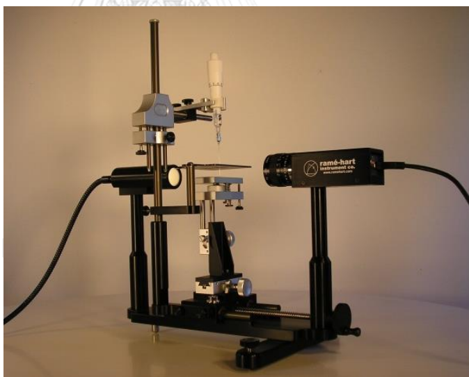
รูปที่ 3.11 เครื่องวัด water contact angle measurement ยี่ห้อ Ramé-hart รุ่น Standard goniometer model 200-F1 [42]
