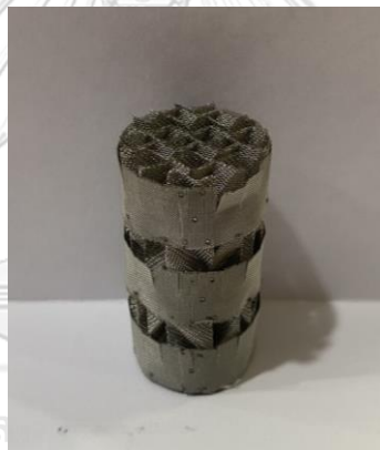
รูปที่ 3.3 วัสดุบรรจุแบบจัดเรียงตัวเป็นระเบียบ Sulzer DX
