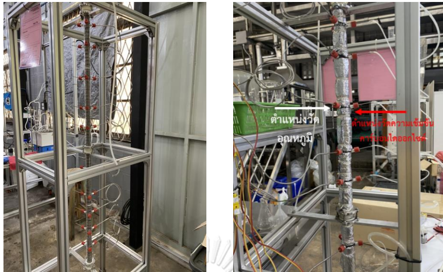
รูปที่ 3.2 หอคูดซึ่มคาร์บอนไดออกไซด์และจุดติดตั้งตัวอย่างสำหรับวัดอุณหภูมิและความเข้มข้นคาร์บอนไดออกไซด์
