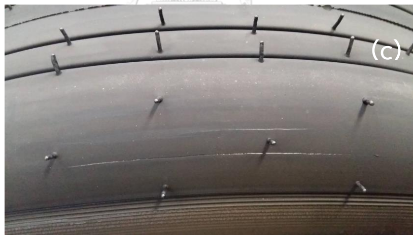
รูปที่ 4.7 แสดงลักษณะการเกิดร่องบนหน้ายางของยางที่มีเก็บไว้ก่อนคงรูปเป็นเวลา (a) 1 วัน (b) 5 วัน (c) 10 วัน
