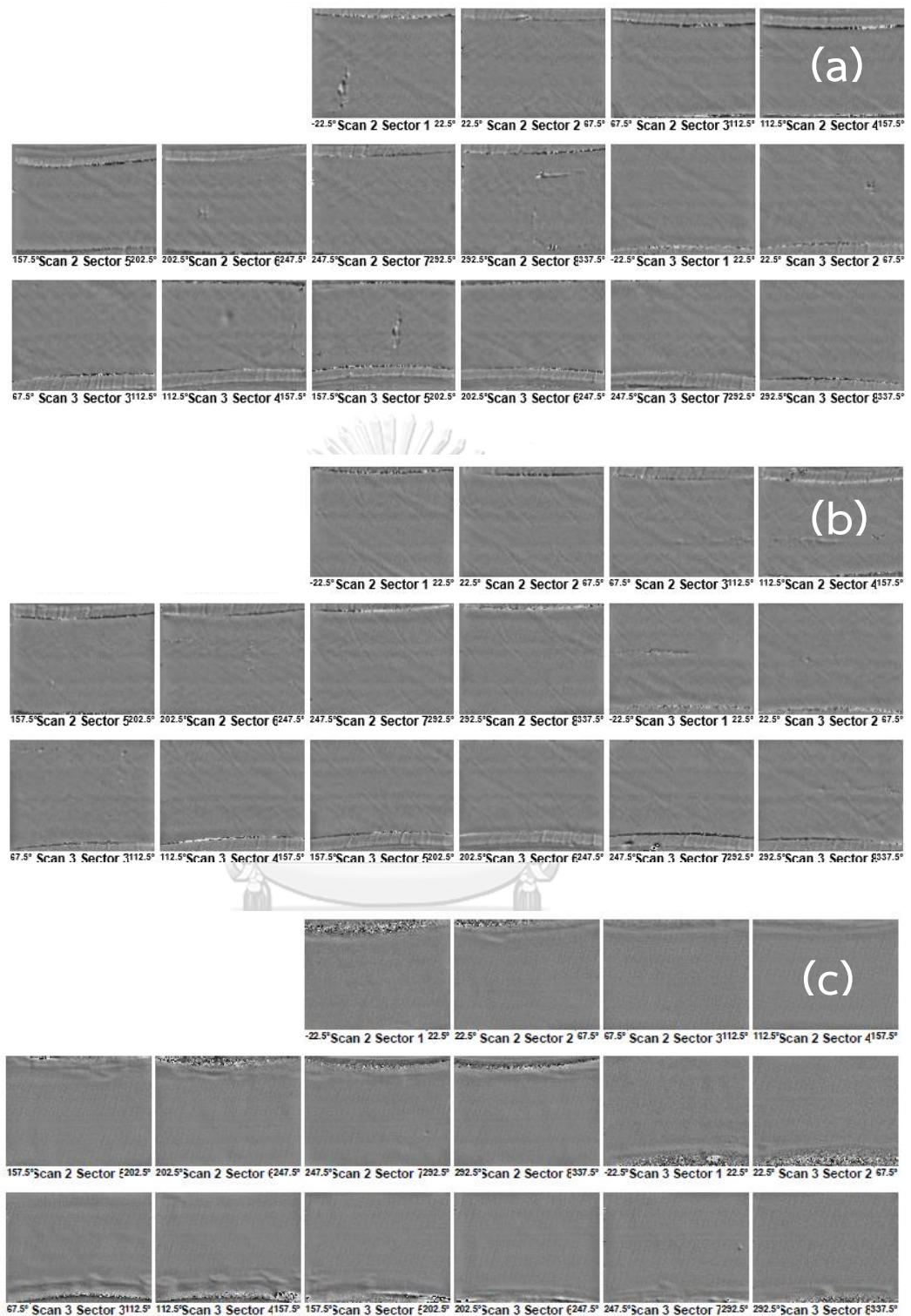
รูปที่ 4.6 แสดงลักษณะภายในโครงยางของยางที่มีเก็บไว้ก่อนคงรูปเป็นเวลา (a) 1 วัน (b) 5 วัน (c) 10 วัน
