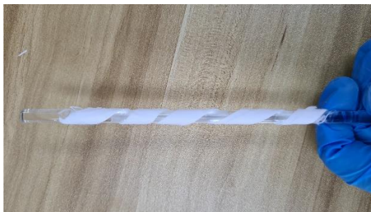
รูปที่ 4. 9 การทดสอบความยืดหยุ่นโดยการบิดโค้งแผ่นเส้นใย
