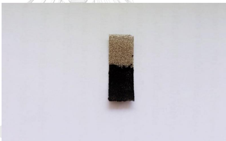
รูปที่ 3.13 ขั้วไฟฟ้าที่เตรียมจากนิกเกิลโพลีเมอร์
