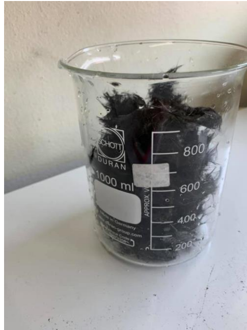
รูปที่ 4.3 เส้นใยคาร์บอนที่ผ่านการดัดแปรผิวด้วยปฏิกิริยาไนเตรชัน
