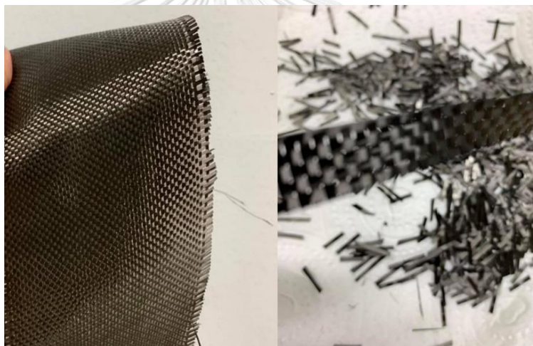
รูปที่ 4.1 เตรียมเส้นใยคาร์บอนจากผ้าคาร์บอน
