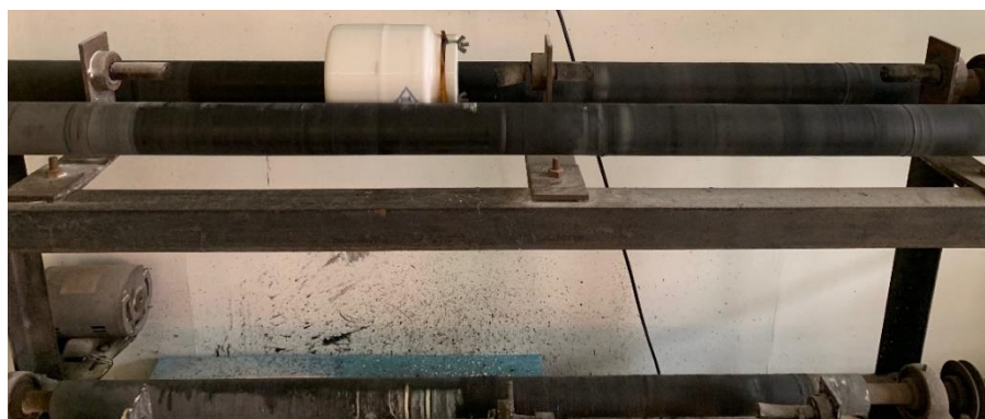
รูปที่ 3.7 แสดงการบดเส้นใยคาร์บอนด้วยเครื่องบดแบบลูกบอล (Ball mill)
