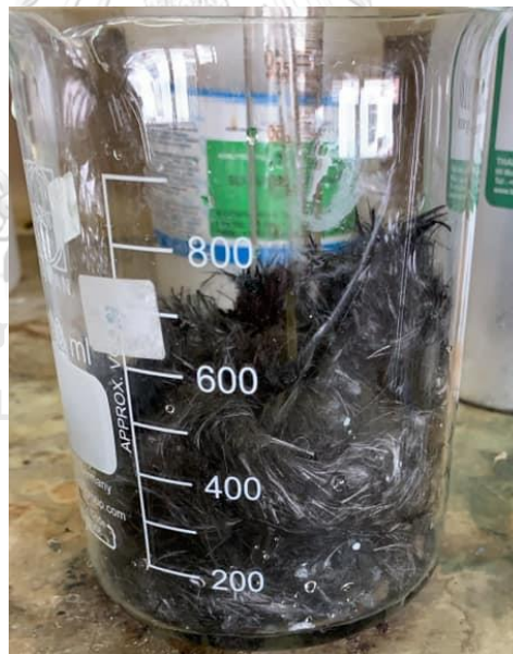
รูปที่ 4.4 เส้นใยคาร์บอนที่ผ่านการดัดแปรผิวด้วยปฏิกิริยารีดักชัน
