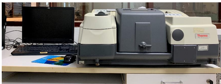
รูปที่ 3.6 เครื่องฟูเรียร์ทรานส์ฟอร์มอินฟราเรดสเปกโทรมิเตอร์
