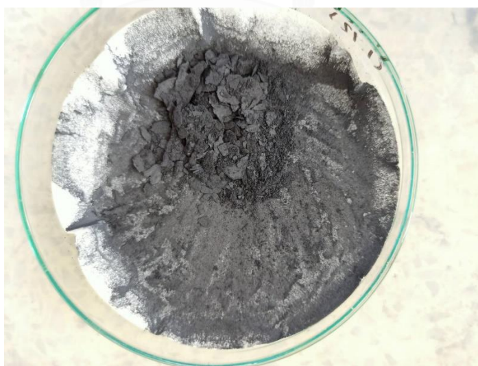
รูปที่ 4.11 แสดงลักษณะของผนังใยคาร์บอนหลังจากทำปฏิกิริยารีดักชัน
