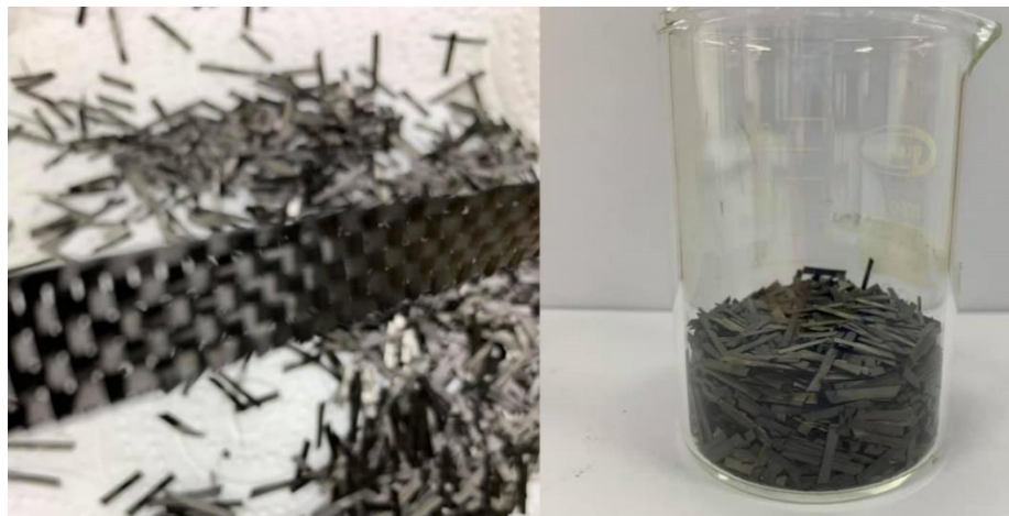
รูปที่ 3.2 ผ้าคาร์บอน ที่นำมาตัดให้ได้ขนาด 1X1 เซนติเมตร
