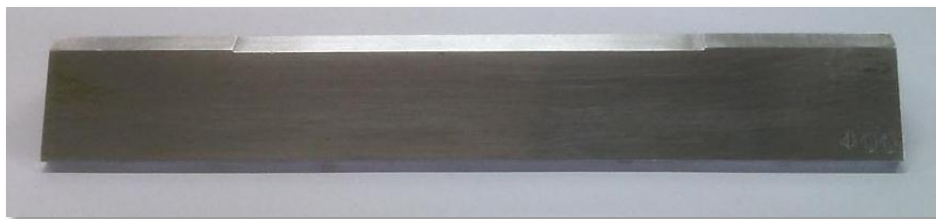
รูปที่ 3.5 เครื่องมือสำหรับเคลือบฟิล์ม (casting bar) ขนาดความหนาชั้นฟิล์ม 400 ไมโครเมตร
