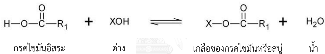
รูปที่ 4.2 สมการเคมีของปฏิกิริยาสะaponนิฟิเคชันกรดไขมันด้วยต่าง ได้ผลิตภัณฑ์เป็นสบู่และน้ำ
