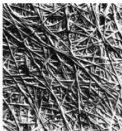
รูปที่ 2 เซลลูโลสจากแบคทีเรียแบบอบแห้งที่ผ่านการส่องด้วยกล้องจุลทรรศน์อิเล็กตรอนแบบส่องกราด [SEM] (Dieter Klemm 2005)
