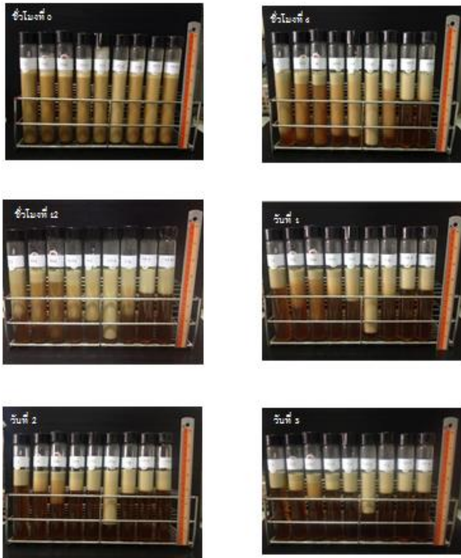
รูปที่ 4.1.10 การแยกชั้นของสารเคลือบผิวเรียงจากซ้ายไปขวา สูตร O (กรดโอเลอิก) OS5 (กรดโอเลอิกผสมโซเดียมโดเดซิลซัลเฟต HLB 5) OS10 (กรดโอเลอิกผสมโซเดียมโดเดซิลซัลเฟต HLB 10) OT5 (กรดโอเลอิกผสมทรีน 80 HLB 5) OT10 (กรดโอเลอิกผสมทรีน 80 HLB 10) T15 (ทรีน 80 HLB 15) TP5 (ทรีน 80 ผสมสแปน 80 HLB 5) และ TP (ทรีน 80 ผสมสแปน 80 HLB 10) ความเข้มข้นสารลดแรงตึงผิว 1.5 เปอร์เซ็นต์โดยมวล ความเร็วรอบในการโฮโมจีไนส์ 4,000 รอบต่อนาที ที่สัปดาห์ที่ 0 ของการผลิตสารเคลือบ
