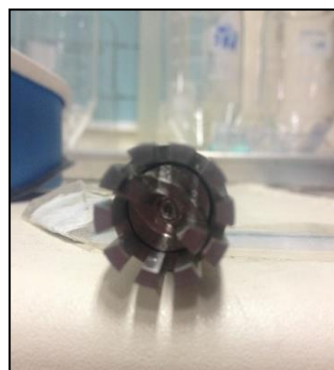
รูปที่ 3.1 แสดงเครื่องโฮโมจีไนส์เซอร์ รุ่น ultra-turrax จากบริษัท IKA® ประเทศมาเลเซีย
