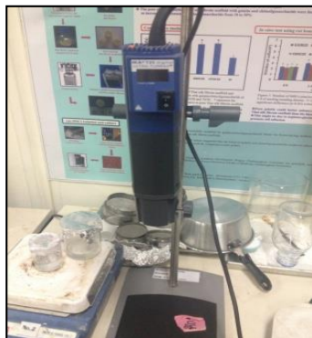
รูปที่ 3.1 แสดงเครื่องโฮโมจีไนส์เซอร์ รุ่น ultra-turrax จากบริษัท IKA® ประเทศมาเลเซีย
