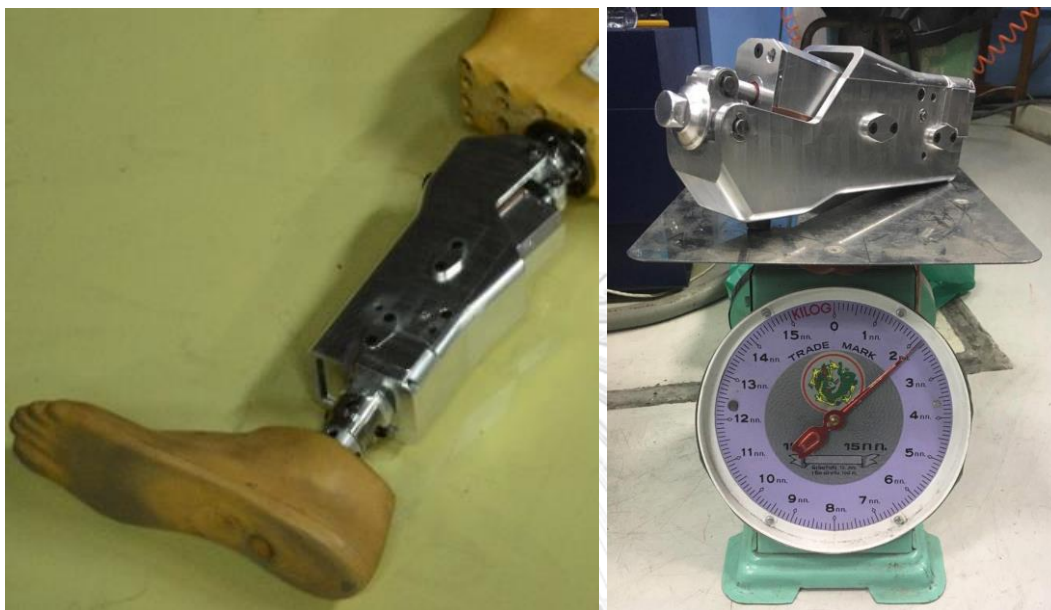
รูปที่ 4.38 ข้อเท้าเทียมระบบไฮดรอลิกที่ประกอบเรียบร้อยแล้ว
