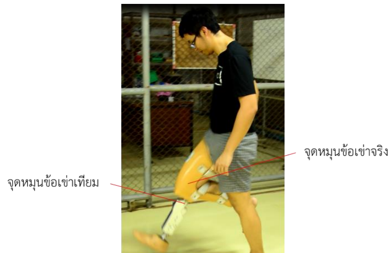
รูปที่ 5.4 การทดสอบข้อเข่าด้วยการใช้งานจริง
