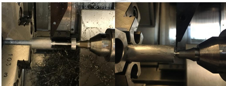
รูปที่ 4.26 ตัวอย่างการกักชิ้นงานบนเครื่อง CNC
