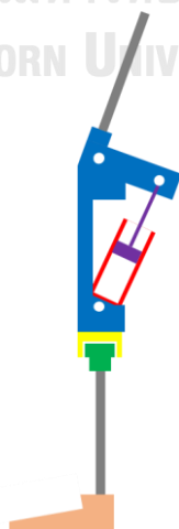
รูปที่ 3.1 โครงสร้างของข้อเข่าเทียมระบบไฮดรอลิกที่ออกแบบ
