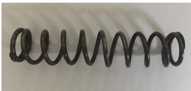
รูปที่ 4.33 สปริงสำหรับดัดข้อเข้าเทียมให้กลับมาตึง
