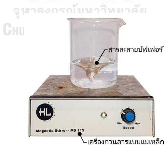
รูปที่ 4.1 การกวนสารละลายด้วยเครื่องกวนสารแบบแม่เหล็ก.
