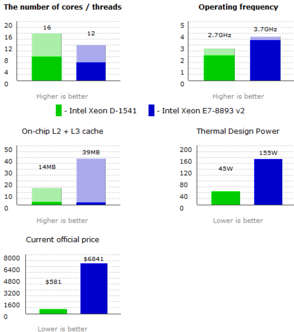
Fig. 57: Intel Xeon D-1541 vs E7-8893 v2 [80].
