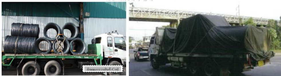
รูปที่ 3-10 ลักษณะการวางสินค้าเหล็กหลอด Wire rod ประเภท Coil และการคลุมผ้าใบ
