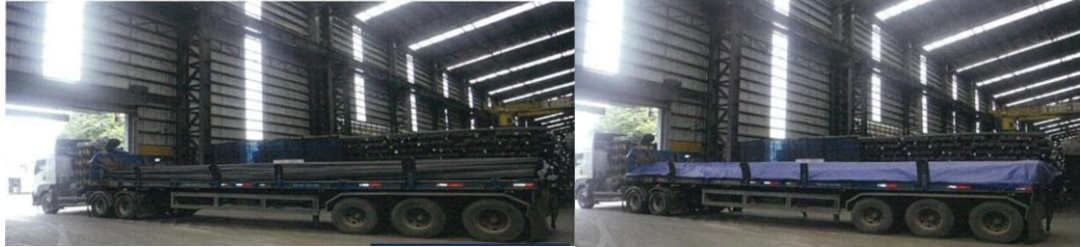
รูปที่ 3-9 ลักษณะการวางสินค้าเหล็กเส้นก่อสร้าง เหล็กเพลา และการคลุมผ้าใบ
