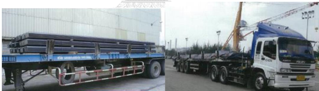
รูปที่ 3-11 ลักษณะการวางสินค้าเหล็กรูปพรรณขนาดเล็ก (Small section) และการคลุมผ้าใบ
