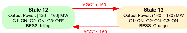
รูปที่ 5.11 การเปลี่ยนแปลงสถานะการทำงานแบบเดิม เมื่อคำสั่งมีการเปลี่ยนแปลงไปมาระหว่างรอยต่อ 160 MW
