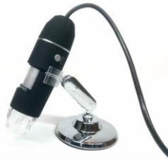
รูปที่ 3-21 กล้องกำลังขยาย 10x ใช้ตรวจสอบรอยร้าว
