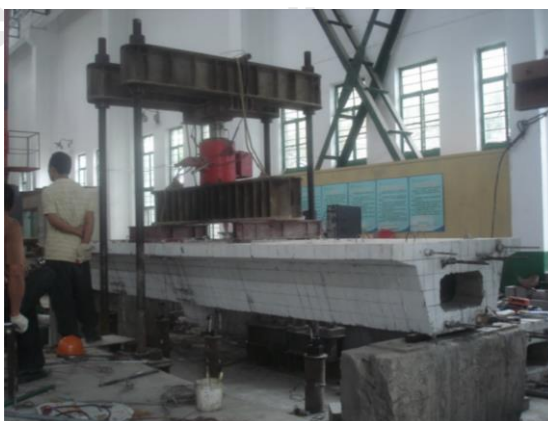
รูปที่ 2-3 คานคอนกรีตอัดแรงประกอบรูปกล่อง (Yuan et al., 2013)
