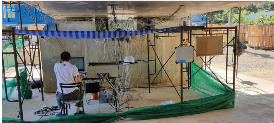
รูปที่ 4-6 Data Locker สำหรับใช้เก็บข้อมูลผลตอบแทนของโครงสร้าง
