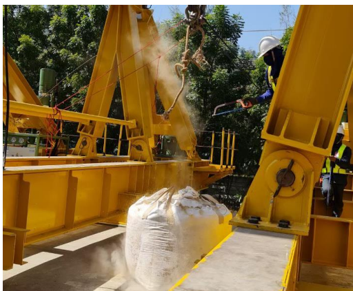
รูปที่ 3-9 การปล่อยมวลตุลทรายเพื่อเหนี่ยวนำให้เกิดการสั่นแบบอิสระ
