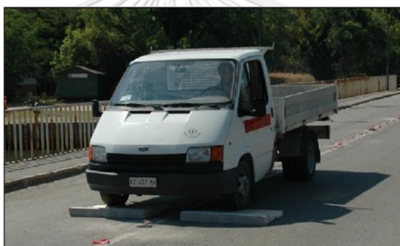
รูปที่ 2-10 การกระทบจากรถบรรทุกเพื่อเหนี่ยวนำให้เกิดพฤติกรรมเชิงพลวัต (Gatti, 2019)
