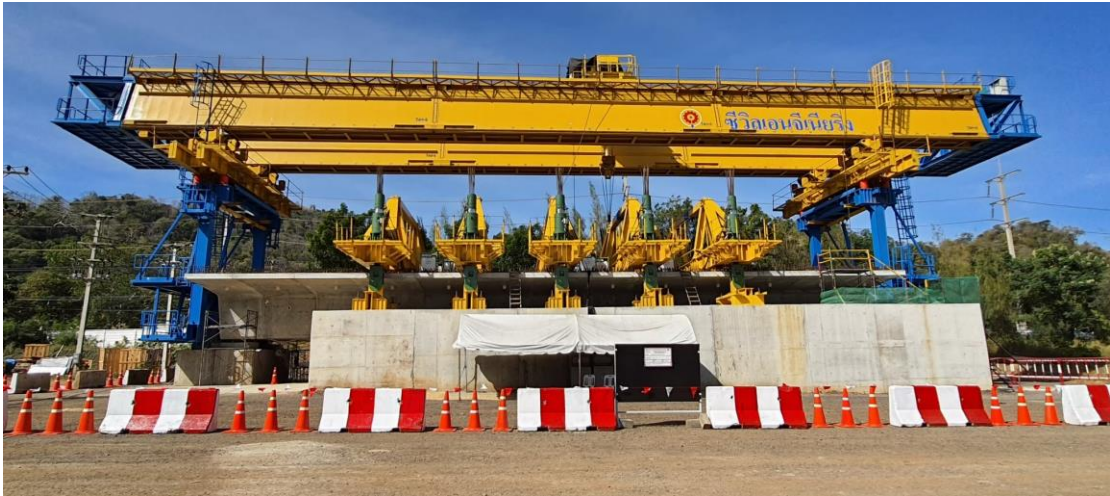
รูปที่ 3-6 การติดตั้งแม่แรงไฮดรอลิกภาคสนามสำหรับการทดสอบแรงดัด (Bending test)
