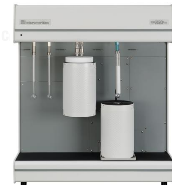
รูปที่ 3.5 เครื่อง Surface area and porosity analyzer ยี่ห้อ Micromeritics รุ่น ASAP 2020
