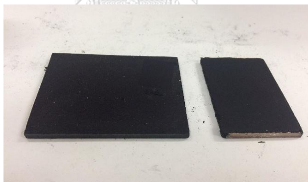
รูปที่ 4.10 ภาพของชิ้นงานที่ขึ้นรูปด้วยเครื่องอัดกระเบื้อง และชิ้นงานที่มีการเคลือบด้วยวัสดุตัวนำ
