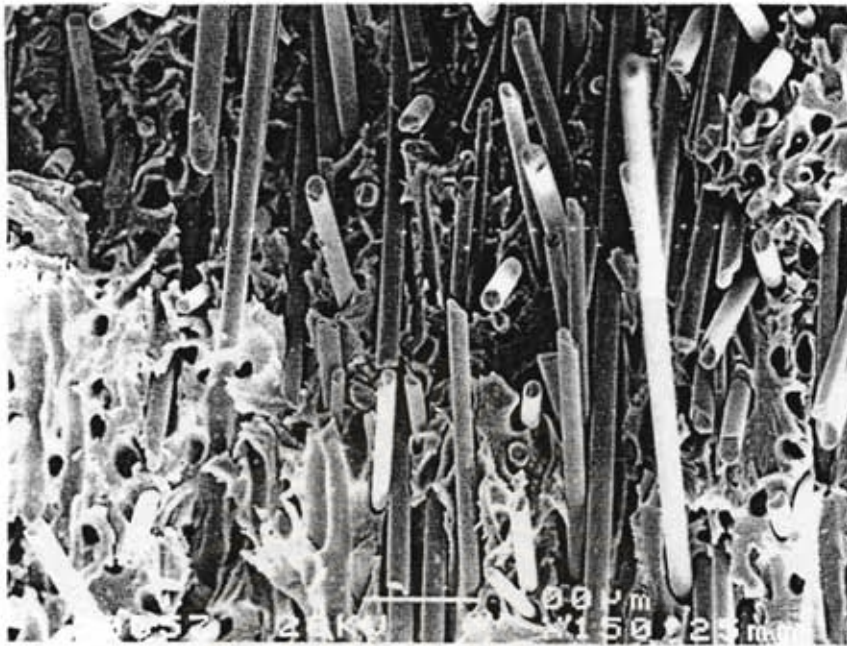
รูปที่ 4.36 ภาพถ่าย SEM บริเวณพื้นที่หน้าตัดของรอยขาด ของพลาสติกพีวีซี เกรด K 58 ที่มีการเติมสารเสริมสภาพพลาสติก สารปรับปรุงแรงกระแทก และเส้นใยแก้ว 30 เปอร์เซ็นต์ โดยน้ำหนัก (กลุ่ม D) กำลังขยาย 150 เท่า
