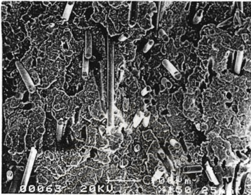
รูปที่ 4.44 ภาพถ่าย SEM บริเวณพื้นที่หน้าตัดของรอยขาด ของพลาสติกพีวีซีเกรด K 64 ที่มีการเติมสารปรับปรุงแรงกระแทก และ เส้นใยแก้ว 10 เปอร์เซ็นต์ โดยน้ำหนัก (กลุ่ม F) กำลังขยาย 150 เท่า
