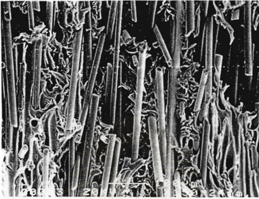
รูปที่ 4.31 ภาพถ่าย SEM บริเวณพื้นที่หน้าตัดของรอยขาด ของพลาสติกพีวีซี เกรด K 58 ที่มีการเติมสารเสริมสภาพพลาสติก และเส้นใยแก้ว 30 เปอร์เซ็นต์ โดยน้ำหนัก (กลุ่ม C) กำลังขยาย 150 เท่า
