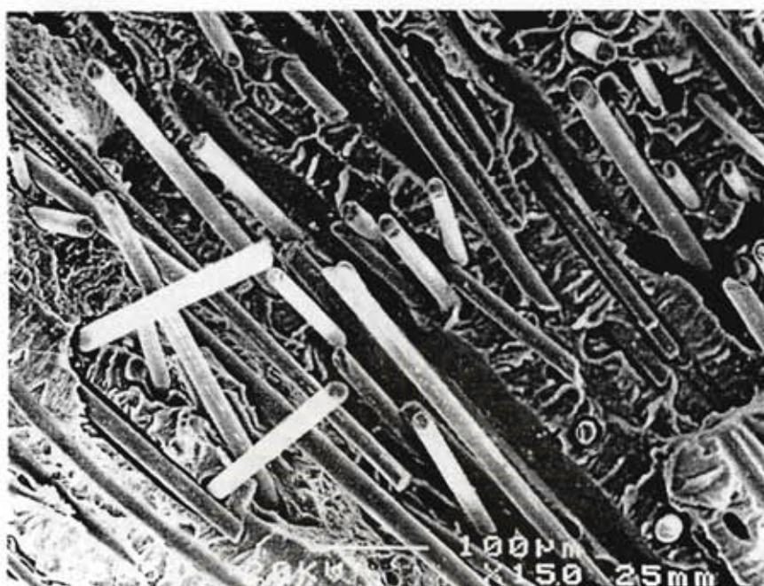
รูปที่ 4.29 ภาพถ่าย SEM บริเวณพื้นที่หน้าตัดของรอยขาด ของพลาสติกพีวีซี เกรด K 58 ที่มีการเติมสารเสริมสภาพพลาสติก และเส้นใยแก้ว 10 เปอร์เซ็นต์ โดยน้ำหนัก (กลุ่ม C) กำลังขยาย 150 เท่า
