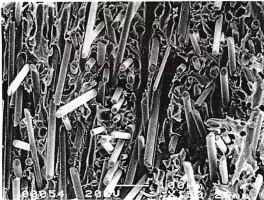
รูปที่ 4.32 ภาพถ่าย SEM บริเวณพื้นที่หน้าตัดของรอยขาด ของพลาสติกพีวีซี เกรด K 58 ที่มีการเติมสารเสริมสภาพพลาสติก และเส้นใยแก้ว 40 เปอร์เซ็นต์ โดยน้ำหนัก (กลุ่ม C) กำลังขยาย 150 เท่า
