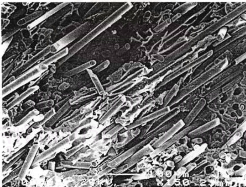
รูปที่ 4.42 ภาพถ่าย SEM บริเวณพื้นที่หน้าตัดของรอยขาด ของพลาสติกพีวีซี เกรด K 64 ที่มีเส้นใยแก้ว 40 เปอร์เซ็นต์ โดยน้ำหนัก (กลุ่ม E) กำลังขยาย 150 เท่า
