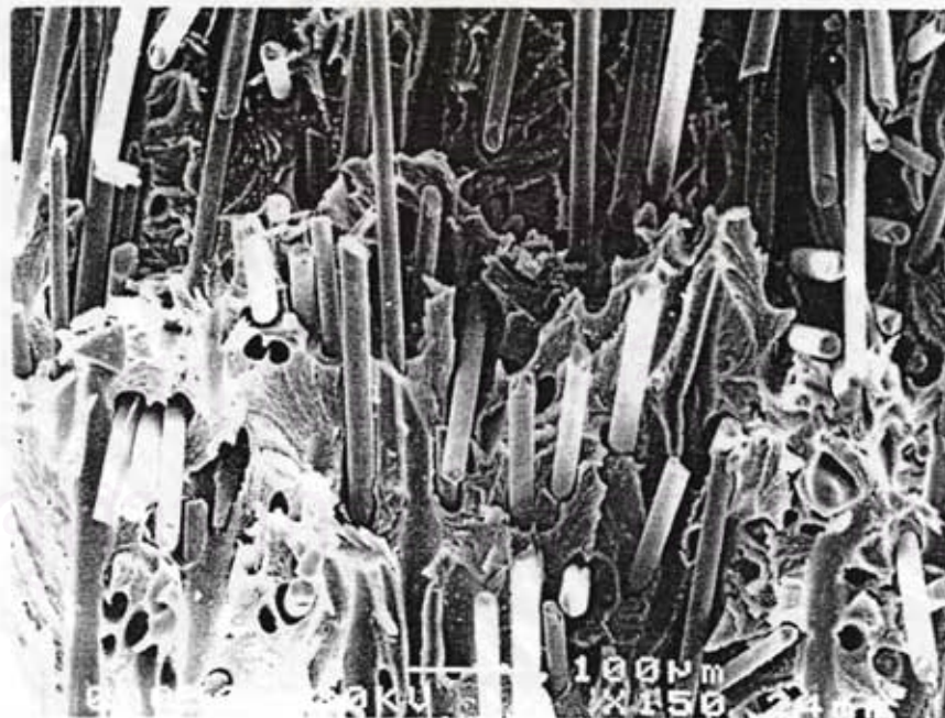
รูปที่ 4.35 ภาพถ่าย SEM บริเวณพื้นที่หน้าตัดของรอยขาด ของพลาสติกพีวีซี เกรด K 58 ที่มีการเติมสารเสริมสภาพพลาสติก สารปรับปรุงแรงกระแทก และเส้นใยแก้ว 20 เปอร์เซ็นต์ โดยน้ำหนัก (กลุ่ม D) กำลังขยาย 150 เท่า
