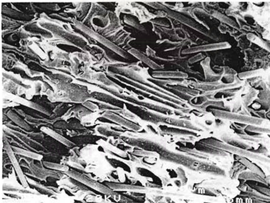
รูปที่ 4.40 ภาพถ่าย SEM บริเวณพื้นที่หน้าตัดของรอยขาด ของพลาสติกพีวีซี เกรด K 64 ที่มีเส้นใยแก้ว 20 เปอร์เซ็นต์ โดยน้ำหนัก (กลุ่ม E) กำลังขยาย 150 เท่า
