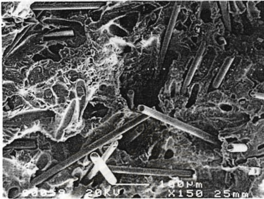
รูปที่ 4.39 ภาพถ่าย SEM บริเวณพื้นที่หน้าตัดของรอยขาด ของพลาสติกพีวีซี เกรด K 64 ที่มีเส้นใยแก้ว 10 เปอร์เซ็นต์ โดยน้ำหนัก (กลุ่ม E) กำลังขยาย 150 เท่า
