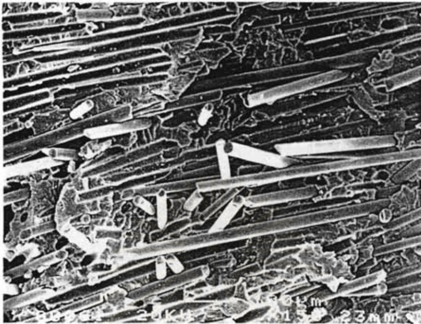
รูปที่ 4.41 ภาพถ่าย SEM บริเวณพื้นที่หน้าตัดของรอยขาด ของพลาสติกพีวีซี เกรด K 64 ที่มีเส้นใยแก้ว 30 เปอร์เซ็นต์ โดยน้ำหนัก (กลุ่ม E) กำลังขยาย 150 เท่า
