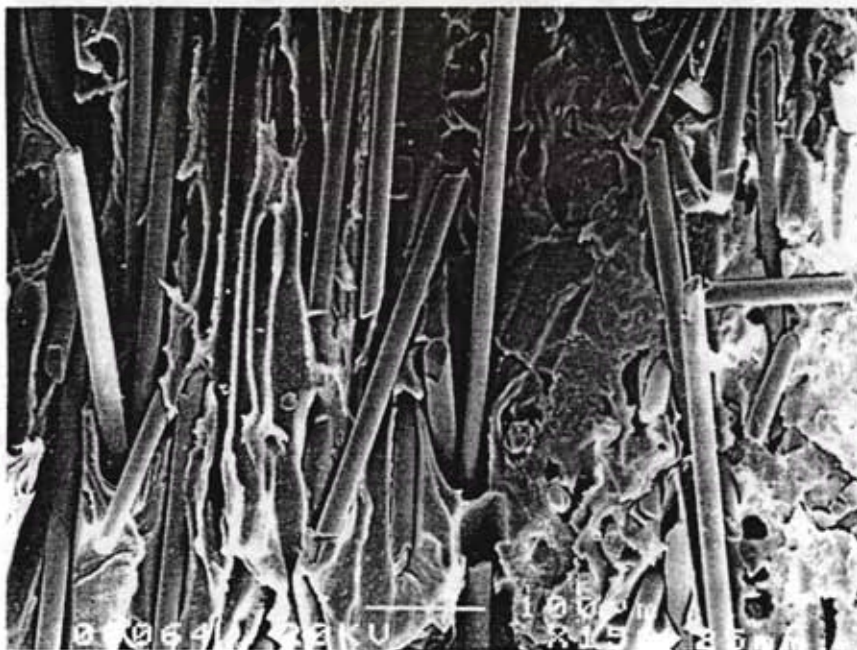
รูปที่ 4.45 ภาพถ่าย SEM บริเวณพื้นที่หน้าตัดของรอยขาด ของพลาสติกพีวีซีเกรด K 64 ที่มีการเติมสารปรับปรุงแรงกระแทก และ เส้นใยแก้ว 20 เปอร์เซ็นต์ โดยน้ำหนัก (กลุ่ม F) กำลังขยาย 150 เท่า
