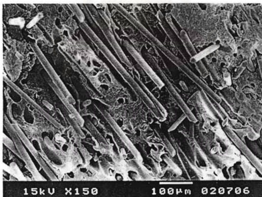
รูปที่ 4.25 ภาพถ่าย SEM บริเวณพื้นที่หน้าตัดของรอยขาด ของพลาสติกพีวีซี เกรด K 58 ที่มีการเติมสารปรับปรุงแรงกระแทก และเส้นใยแก้ว 20 เปอร์เซ็นต์ โดยน้ำหนัก (กลุ่ม B) กำลังขยาย 150 เท่า
