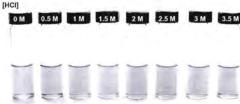
รูปที่ 25 แสดงสีของสารละลายที่เกิดจากการเกาะตัวกันของอนุภาคนาโนของทองโดยมีน้ำนมที่อัตราส่วนการเจือจาง 1:200 เป็นตัวควบคุม ในสารละลายที่มีความเข้มข้นของกรดไฮโดรคลอริกเท่ากับ 0 - 3.5 M จะเห็นว่าสีที่เกิดขึ้นไม่มีความแตกต่างกันมากนัก แต่มีแนวโน้มที่จะมีสีม่วงมากขึ้นเมื่อความเข้มข้นของกรดมากขึ้น
