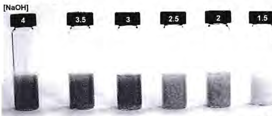
รูปที่ 18 แสดงสีของสารละลายที่ได้จากการทำปฏิกิริยาระหว่าง \text{HAuCl}_4 ที่ pH 3 และนมที่เจือจางใน NaOH 4, 3.5, 3, 2.5, 2 และ 1.5 M ที่เวลา 5 นาที
