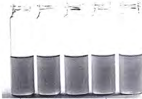
รูปที่ 23 แสดงสีของสารละลายที่เกิดจากปฏิกิริยาของ \text{HAuCl}_4 ที่ความเข้มข้น 200 ppm จะเห็นว่า สีของสารละลายเป็นสีเทาทั้งหมด ทำให้ไม่สามารถใช้บ่งบอกอัตราส่วนการเจือจางของน้ำนมได้
