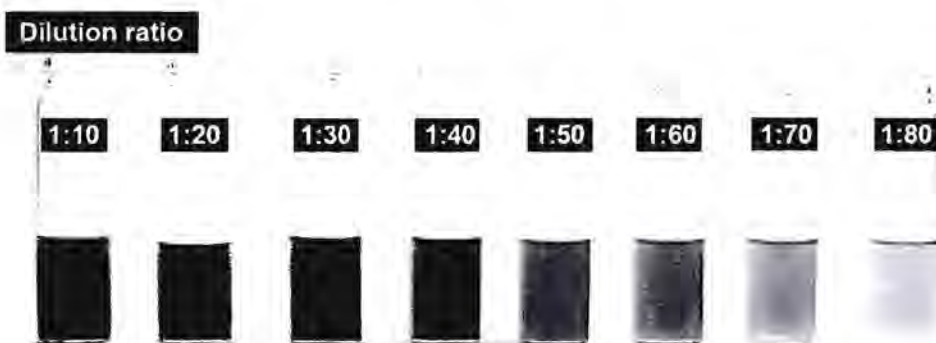
รูปที่ 21 แสดงสีของสารละลายที่เกิดจากการผสมระหว่าง \text{HAuCl}_4 ความเข้มข้น 500 ppm pH 3 ปริมาตร 5 mL กับน้ำตาลที่เจือจางด้วยอัตราส่วน 1:10 - 1:80 ใน NaOH 3 M ปริมาณ 5 mL ที่เวลา 10 นาที
