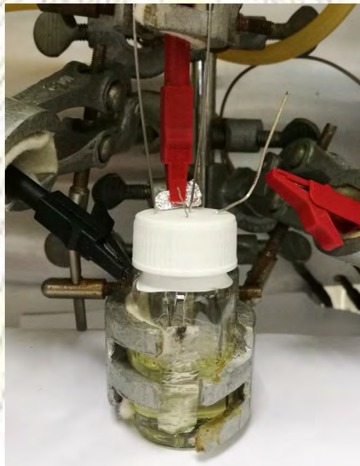
รูปที่ 9 เซลล์ไฟฟ้าสำหรับการสร้างฟิล์มของสารประกอบซิงค์เฟส
