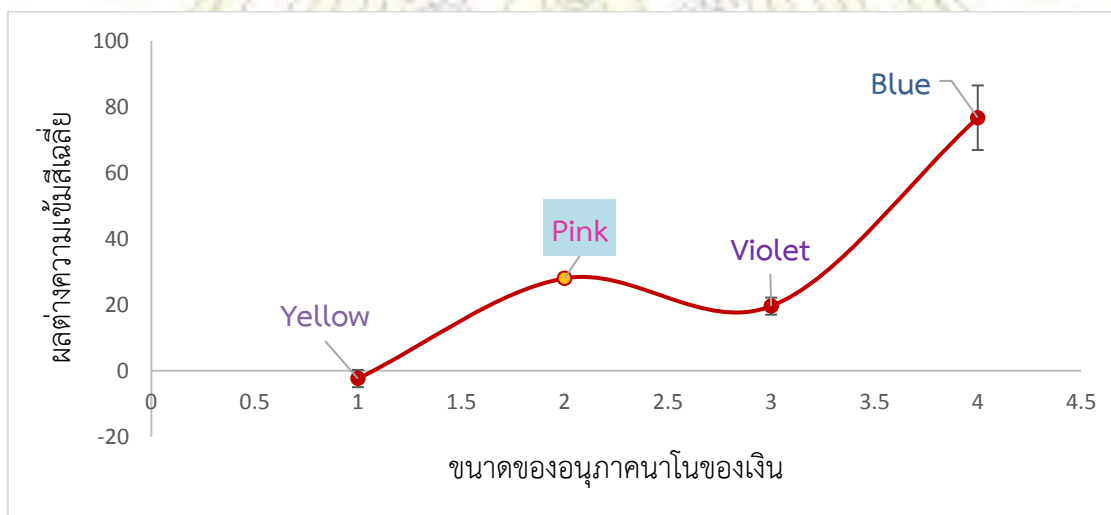
รูปที่ 3.3 กราฟแสดงความสัมพันธ์ระหว่างค่าผลต่างความเข้มสีเฉลี่ยกับขนาดของอนุภาคนาโนของเงิน
