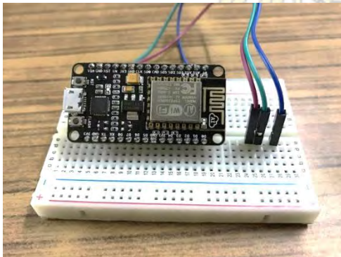
รูปที่ 2.11 การเชื่อมต่อไมโครคอนโทรลเลอร์กับเบรตบอร์ด
