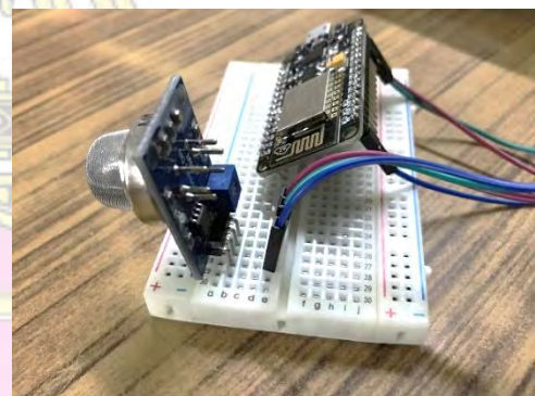
รูปที่ 2.12 การเชื่อมต่อโมดูลกับเบรตบอร์ด
