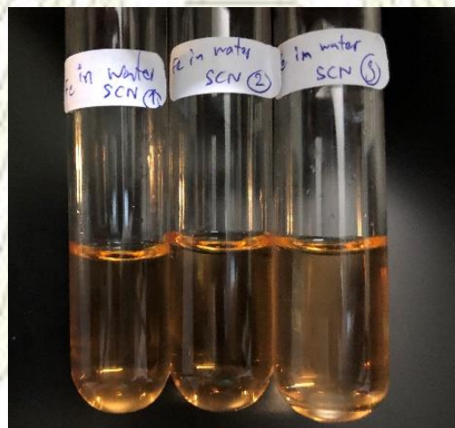
ภาพที่ ผ4 ลักษณะที่สังเกตได้จากหลอดปฏิบัติการระหว่างไอออน Fe(III) กับ thiocyanate ในน้ำ
