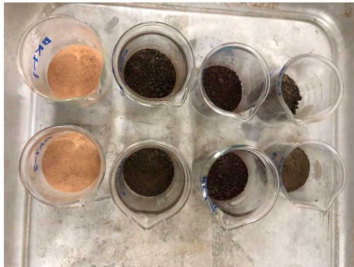
รูปที่ 8 รูปแสดงการเตรียมตัวอย่างสำหรับการหาค่าร้อยละของปริมาณน้ำในตัวอย่าง ( W )
