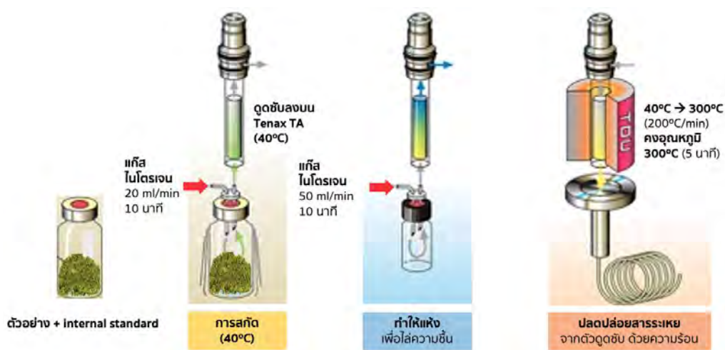
ภาพที่ 3.9 การสกัดแบบไม่ใช้ตัวทำละลายด้วย DHS, การดูดซับ, และปลดปล่อยสารระเหย (ที่มา : ดัดแปลงจาก www.gerstel.com )
