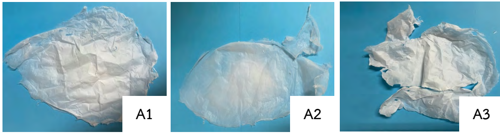
รูปที่ 3.1 ลักษณะของเส้นใยที่เตรียมได้จากสารละลายพอลิแล็กติกโคไกลโคลิกแอซิดในตัวทำละลายผสมระหว่างคลอโรฟอร์มและไดเมทิลฟอร์มาไมด์ (A1) 10 %w/v, (A2) 15 %w/v และ (A3) 17 %w/v
