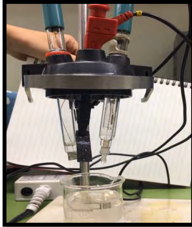
รูปที่ 3.1 การอิเล็กโทรไลต์ด้วยเครื่องกัลวานอสแตท ( Potentiostat/galvanostat )
