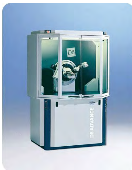
รูปที่ 3.4 เครื่องวัดการเลี้ยวเบนรังสีเอกซ์ BRUKER model D8 Advance [25]
