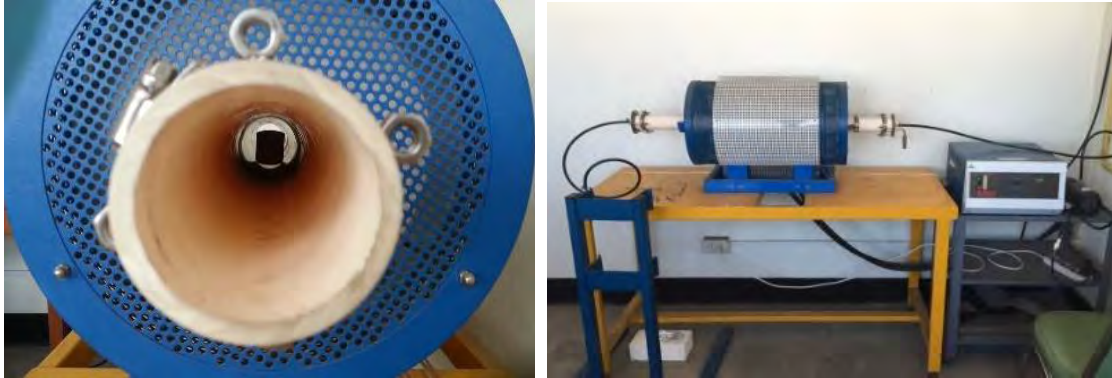
รูปที่ 3.3 นำถ้วยหลอมสารเข้าไปไว้ที่ตรงกึ่งกลางของท่อหลอมและการจัดเตรียมระบบเตาหลอม
