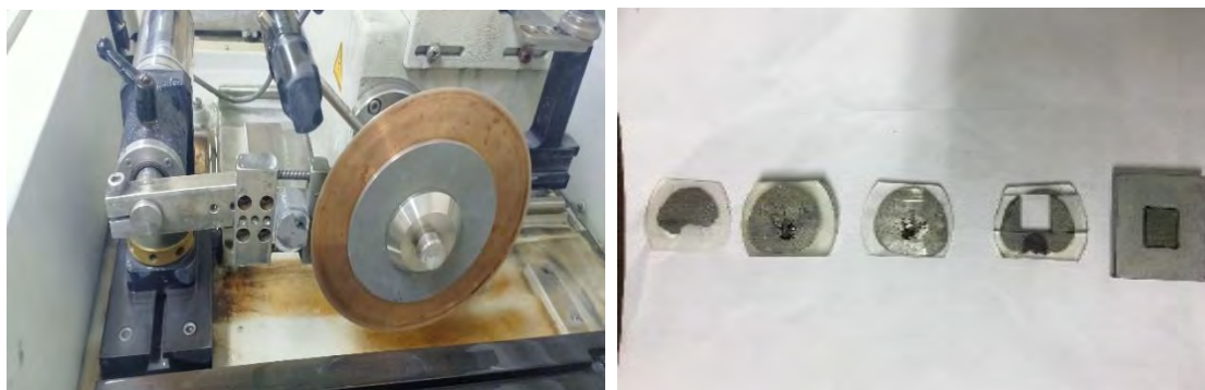
รูปที่ 3.6 ตัดชิ้นงานตามแนวขวางของชิ้นงาน สารที่ตัดจนมีขนาด 1x1 เซนติเมตร
