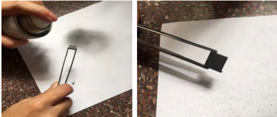
รูปที่ 3.7 พ่นสเปรย์แกรไฟต์เคลือบชิ้นงานให้ทั่วทั้งชิ้น
