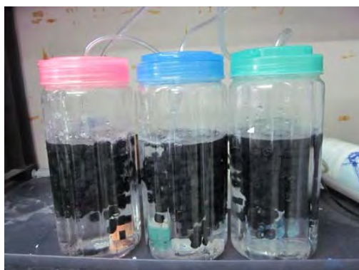
รูปที่ 3.6 การติดตั้งอุปกรณ์สำหรับการตรวจวัดอัตราการบำบัดไนไตรต์ของตัวกลางพลาสติกที่ผ่านการตรึงเชื้อและคัดเลือกให้เหลือเฉพาะแบคทีเรียกลุ่ม NOB
