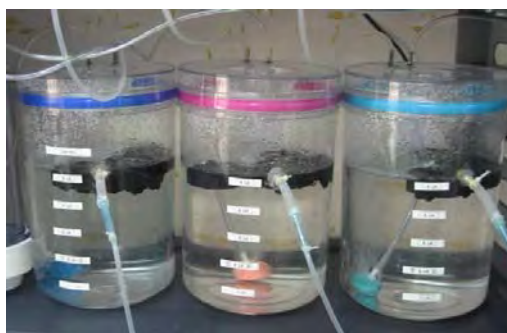
รูปที่ 3.5 ชุดปฏิกรณ์ที่ใช้ในการคัดเลือกไนโตรไฟอิงแบคทีเรียกลุ่ม NOB บนตัวกลางพลาสติก
