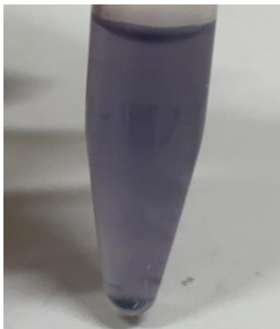
รูปที่ 4.8 แสดงให้เห็นอนุภาคทองคำนาโนที่สังเคราะห์ได้ตกตะกอนที่ก้นหลอดหลังจากทำการปั่นเหวี่ยง
