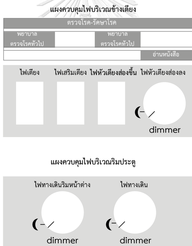
ภาพที่ 5.3 ตัวอย่างแผนควบคุมการเปิดปิดโดยการใช้สวิตช์แยกแต่ละดวงโคมและอุปกรณ์ปรับหรือแสง
