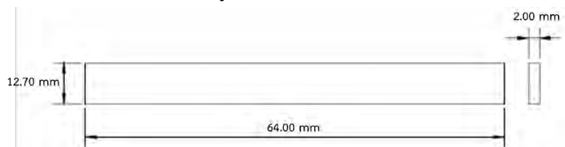
รูปที่ 3.11 ตัวอย่างชิ้นทดสอบแรงดัดโค้งตามมาตรฐาน ASTM D790
